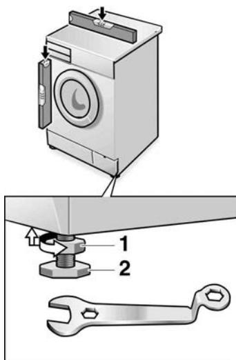
Выравнивание стиральной машины по горизонтали и вертикали проводится с помощью регулируемых по высоте ножек машины и ватерпаса:
